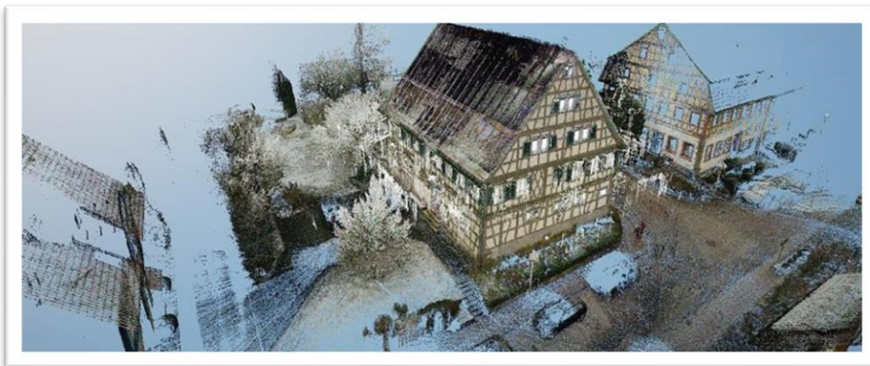
Abbildung 3 Ansicht Pfarrgebäude aus Punktwolke
